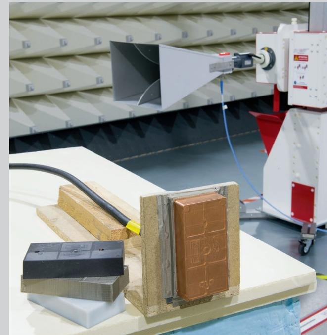
Gehäusemessung nach EN 61000-5-7 in Absorberhalle
